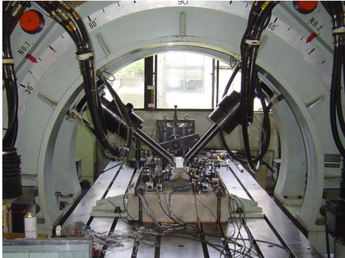
せん断型締結装置およびALTJ-1型締結装置について、下記の条件にて試験を行いました結果、締結装置の各部品には異常は認められませんでした。
